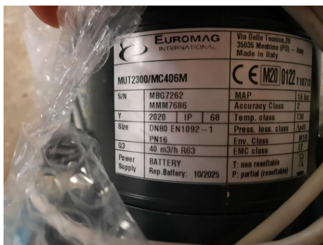
Obr. 2 – Výrobný štítok vodomera MUT2300
